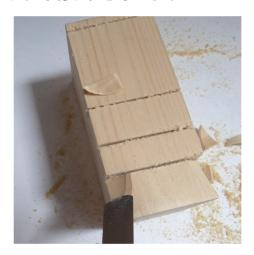
輪郭を削り出していきます。 いちどにたくさん削ろうとしないで、 前後の角をけずり、間をつなぐように。浅い丸刀か平刀で直線的におとします。
